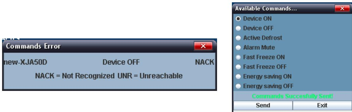
图中英文命令含义：Device OFF：关闭控制器； Device ON：打开控制器； Active Defrost：激活融霜； Keyboard LOCK：锁定键盘； Keyboard UN-LOCK：解锁键盘； Alarm Mute：报警静音； Energy saving Active：激活节能运行； Energy saving NOT Active：取消节能运行； Commands sent with errors!：命令发送错误！。
