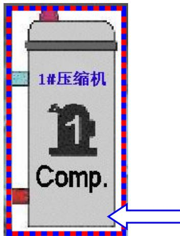
当到达蓝色箭头位置时释放鼠标左键，移动到合适位置再点击一次鼠标左键；如果选择多个输出状态使用“Motion=动态方框”，就会重复出现上面的窗口，修改完属性后，重复本操作即可添加更多的动态方框。
