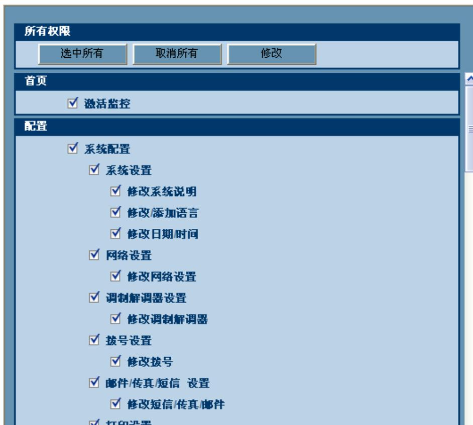
在此窗口中允许您通过勾选/取消勾选来为这个用户分配他的权限，您可以点击“Enable all 选中所有”来勾选全部选项，或“Disable all 取消所有”来取消勾选全部选项，确认完成之后请点击右上角的“Modify 修改”按钮，在弹出的询问对话框中点击“确定”按钮，等待刷新屏幕后，逐级关闭窗口，可以尝试退出系统再使用其他用户登录进入系统。
